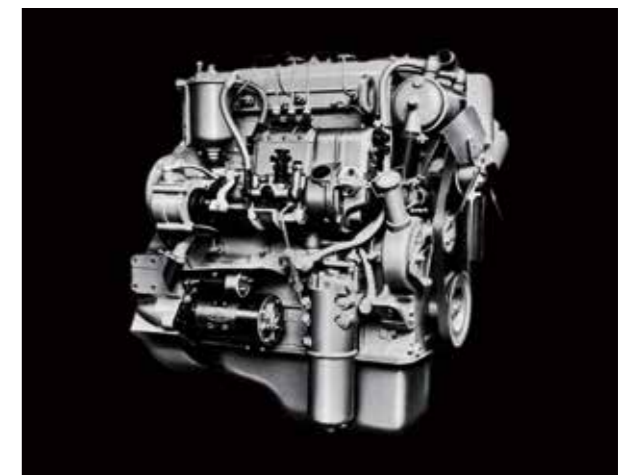
1955年1月に発表されたUDエンジン。ハイパワーな2サイクルエンジンの特長を最大限に活かしつつ、単流掃気方式を採用することで、掃気効率の改善と、低騒音・小型軽量化の両立を図ることに成功した。
