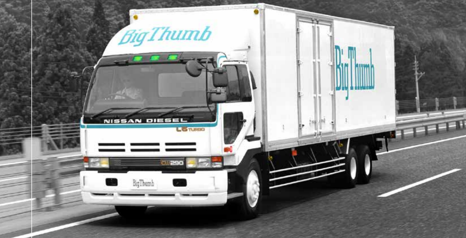
1990年発売のビッグサム。 フラッシュサーフェスを採用したキャビンは空力特性に優れ、街と調和するデザインが好評だった。新型低公害・低燃費エンジンの搭載で当時、世界で最も厳しい日本の排出ガス規制をクリアしている。
